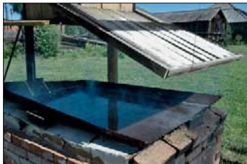
Макет сковороды — плоской ёмкости для выпаривания соли.
