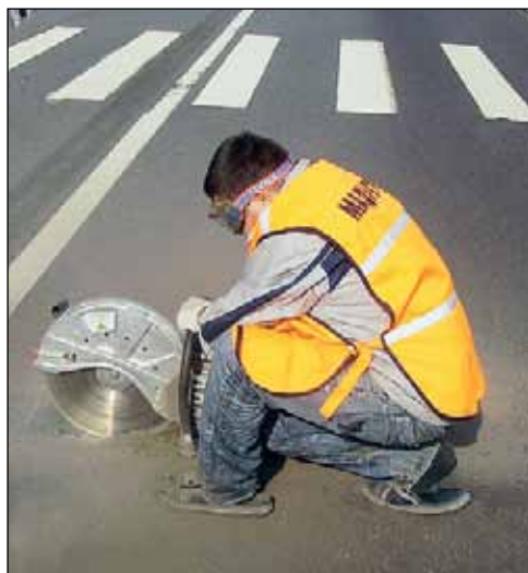
Из полотна с помощью механической пилы вырезают прямоугольные образцы для отправки в лабораторию.
